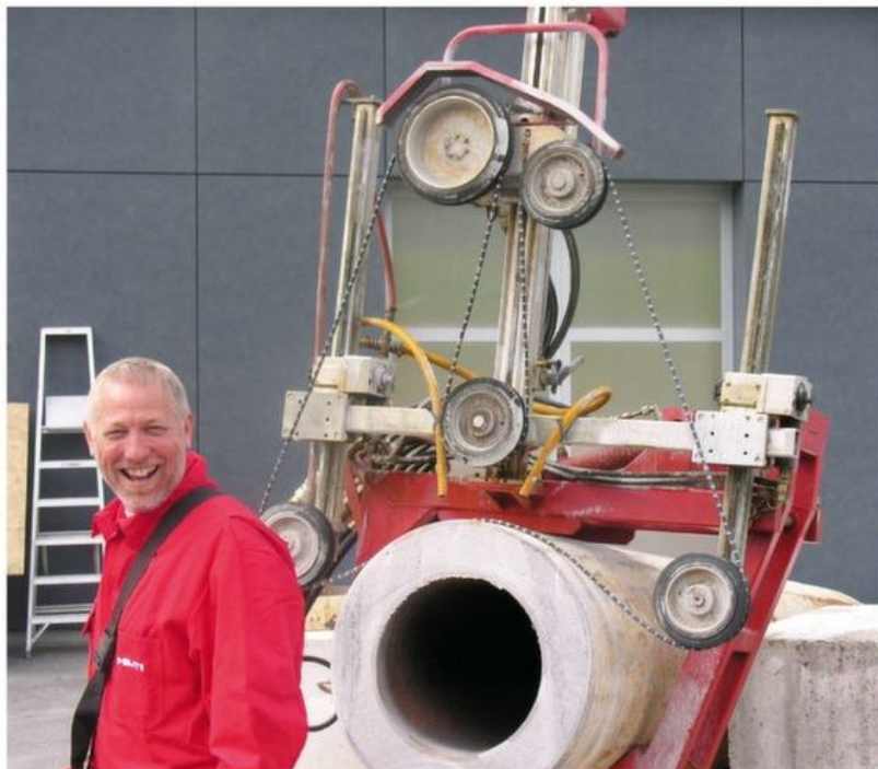
Sigi: Der Zeitpunkt war reif, ein eigenes Unternehmen zu gründen. Hier demonstriert er den Ingenieuren aus dem Offshore-Geschäft eine hydraulische Diamant-Rohrseilsäge.
