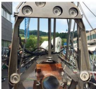
Unterwasser-Rohrseilsäge für \varnothing 950 bis 1500 mm.
